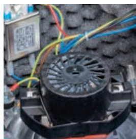
idealne wygłuszenie przedziału turbiny
